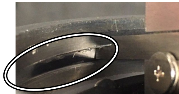
正常加工の保持クリップの組み付け溝
