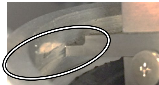
加工不良の保持クリップの組み付け溝
