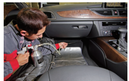
エアコンクリーニングの作業。スプレーガンとノズルで溶剤を吹きエバポレーターの汚れを落とす。22,000円から27,000円。
