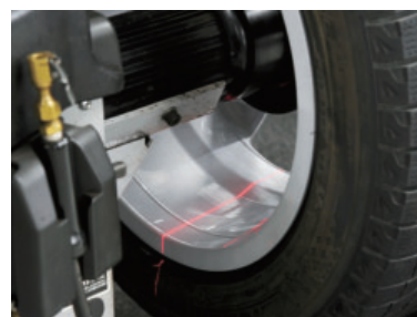
荷重を掛けながら適正なバランスウエイトを測定するホイールバランスサー。赤い線がレーザー照射。どこにどれだけのウエイトをつけるか示してくれる。
