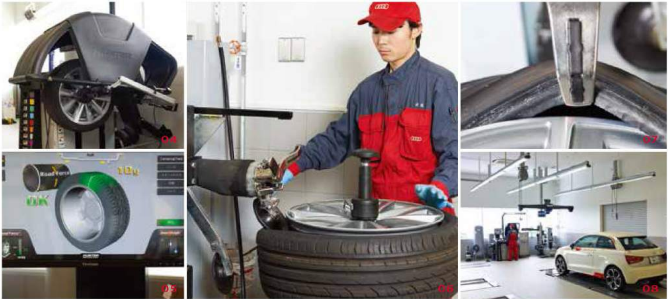
O1 :リフトアップされ、タイヤ交換を待つA1。 O2・O3・O4・O5 :ロードローラーによるロードフォース測定システムを備えたホイールバランス。測定した数値をモニター画面で確認しながら、精度の高いホイールバランス調整が可能です。 O6・O7 :大径21インチにも対応したタイヤチェンジャー。レーザーポインターで位置決めをすることで、ホイールを傷つけずにスムーズなタイヤの取り外し/取り付けが可能です。 O8 :最新鋭の設備が整った、広く明るいAudi正規ディーラーの整備場。
